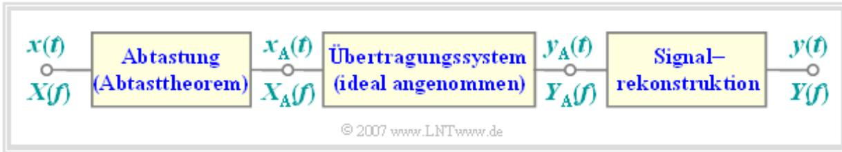
Das Analogsignal  $x(t)$  mit Bandbreite  $B_{NF}$  wird wie oben beschrieben abgetastet. Am Ausgang eines idealen Übertragungssystems liegt das ebenfalls zeitdiskrete Signal  $y_A(t) = x_A(t)$  vor. Die Frage ist nun, wie der Block **Signalrekonstruktion** zu gestalten ist, damit auch  $y(t) = x(t)$  gilt.
