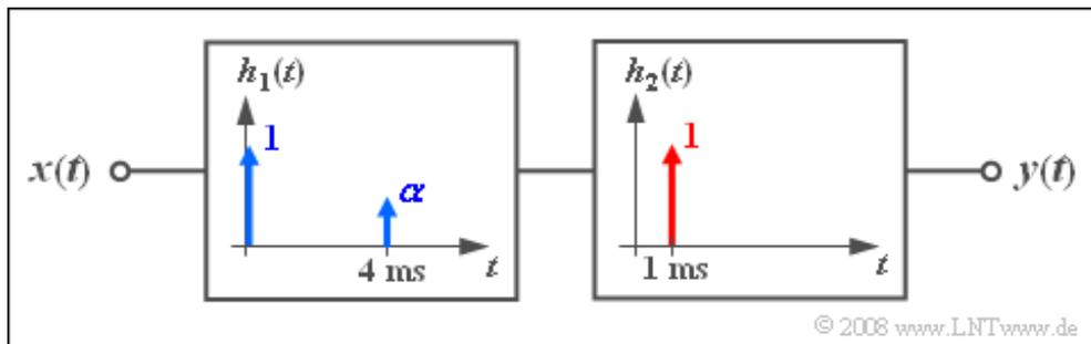
Die Übertragungsfunktion  $H_1(f)$  ist wie unter b) berechnet. Für  $H_2(f)$  gilt mit  $\tau_1 = 1 \text{ ms}$ :
