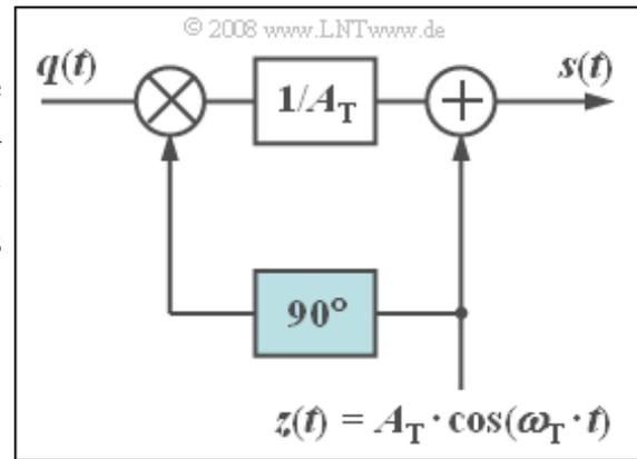
Der zweite Term beschreibt eine ZSB-AM ohne Träger. Zusätzlich wird der um 90° phasenverschobene Träger addiert. Bei cosinusförmigem Quellensignal
