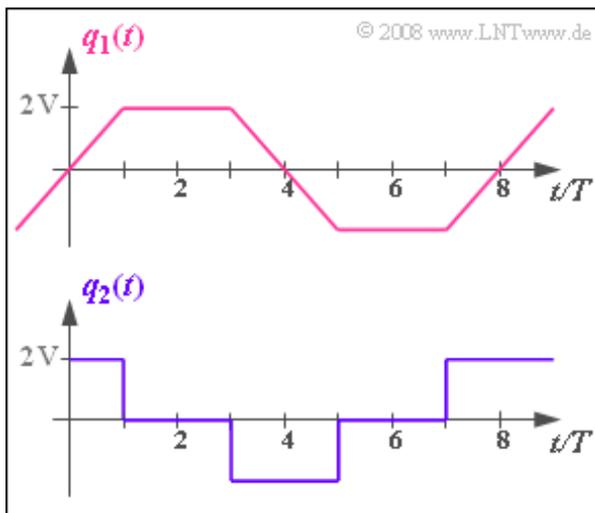
Als Testsignal wird das oben skizzierte Trapez-Signal  $q_1(t)$  angelegt, wobei die Normierungszeitdauer  $T = 10 \mu\text{s}$  beträgt.
