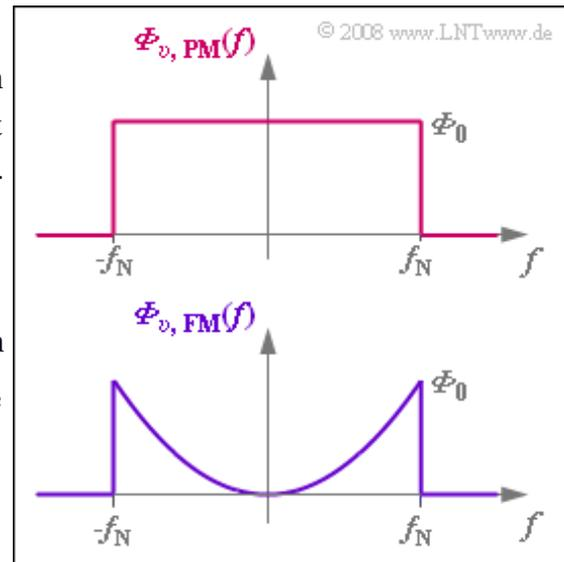
Für die Berechnung der Rauschleistung  $P_R$  ist lediglich der Frequenzbereich von  $\pm f_N$  relevant (siehe Grafik).
