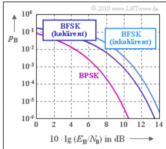
Diesem Systemvergleich liegt wieder der AWGN-Kanal zugrunde, gekennzeichnet durch das Verhältnis  $E_B/N_0$ . Die Gleichungen für die Bitfehlerwahrscheinlichkeiten lauten bei
