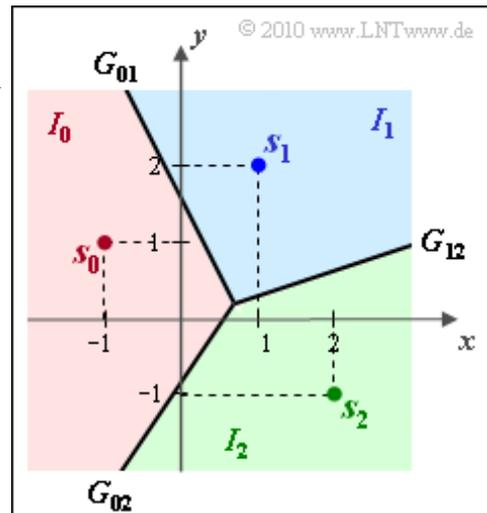
Die beiden Achsen des 2D-Signalraums sind hier vereinfachend mit  $x$  und  $y$  bezeichnet; eigentlich müsste hierfür  $\varphi_1(t)/E^{1/2}$  bzw.  $\varphi_2(t)/E^{1/2}$  geschrieben werden.
