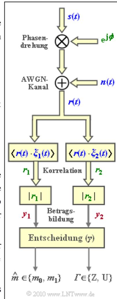
Gegenüber dem im **Theorieteil** angegebenen Entscheidungsprozess wird nun ein komplizierterer Entscheider betrachtet, der außer dem Schätzwert noch ein *Sicherheitsflag*  $\Gamma = \{„Z“, „U“\}$  ausgibt. „Z“ und „U“ stehen hierbei für eine zuverlässige bzw. eine unzuverlässige Entscheidung. Es gibt also vier Möglichkeiten der Entscheidung, gesteuert durch den Parameter  $\gamma$ :
