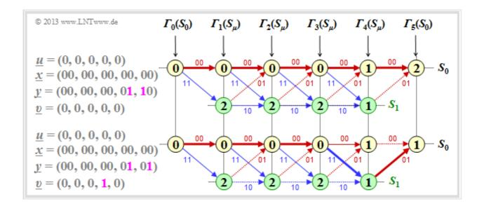
a) Ausgehend von  $\Gamma_2(S_0) = 0$ ,  $\Gamma_2(S_1) = 2$  erhält man mit  $\underline{y}_3 = (01)$ :
