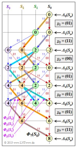
a) Der Zustand  $S_0$  muss entsprechend nebenstehender Grafik in einen Startzustand  $S_0$  und einen Endzustand  $S_0$ ' aufgespalten werden. Der Grund hierfür ist, dass für die folgende Berechnung der Pfadgewichtsfunktion T(X, U) alle Übergänge von  $S_0$  nach  $S_0$  ausgeschlossen werden müssen.
