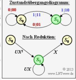
Bei einem blauen Übergang im ursprünglichen Diagramm – dies steht für  $u_i = 1$  – ist im modifizierten Diagramm der Faktor U hinzuzufügen. Aus der nebenstehenden Grafik erkennt man, dass die <u>Lösungsvorschläge 1, 3, 4 und 5</u> richtig sind.
