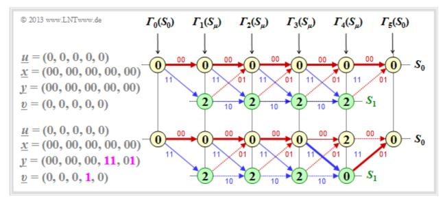
Für das untere Trellis gehen wir ebenfalls von  $\underline{u}=(0,\ 0,\ 0,\ 0,\ 0)\Rightarrow\underline{x}=(00,\ 00,\ 00,\ 00,\ 00)$  aus. Empfangen wird aber nun  $\underline{y}=(00,\ 00,\ 00,\ 11,\ 01)$ . Trotzdem gilt  $\Gamma_5(S_0)=0$ . Das Beispiel belegt, dass die beiden ersten Aussagen falsch sind. Richtig ist hier nur der <u>Lösungsvorschlag 3</u>, da das Ereignis "Kein Übertragungsfehler" sehr viel wahrscheinlicher ist als drei Fehler an genau vorgegebenen Positionen.
